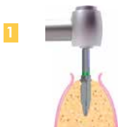
Foret à quatre lames de Ø 3,8 mm Réf. X1238 (Foret final os peu minéralisé)
